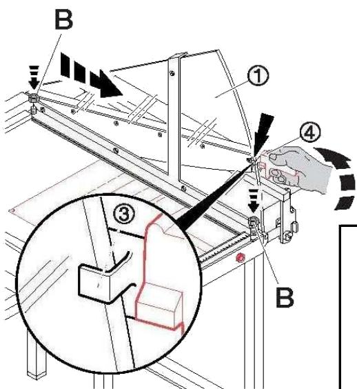
①紙押一体型安全カバーをイラストを参考頂き本体に取付けます。
