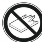
この裁断機は、普通紙（上質コピー用紙64g/m<sup>2</sup>）を任意の寸法に裁断する目的で設計・製造されておりますので硬質の素材や木片・金属片等のような物は絶対に裁断しないでください。
